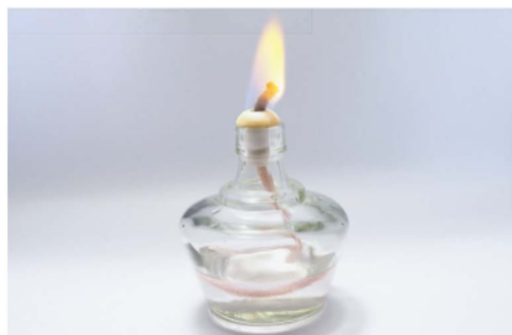
Hình 6.1. Đèn cồn dùng trong phòng thí nghiệm có nhiệt độ ngọn lửa cao.
