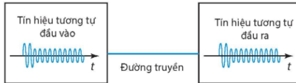
Hình 5.4. Truyền dẫn bằng tín hiệu tương tự
