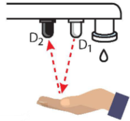
Hình 9.9. Mô hình vòi nước rửa tay tự động: D_1 là diode thu hồng ngoại, D_2 là diode thu hồng ngoại
