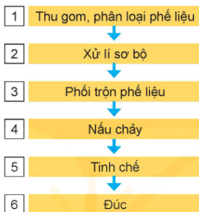
Hình 4.2. Minh họa quy trình chung về tái chế kim loại
