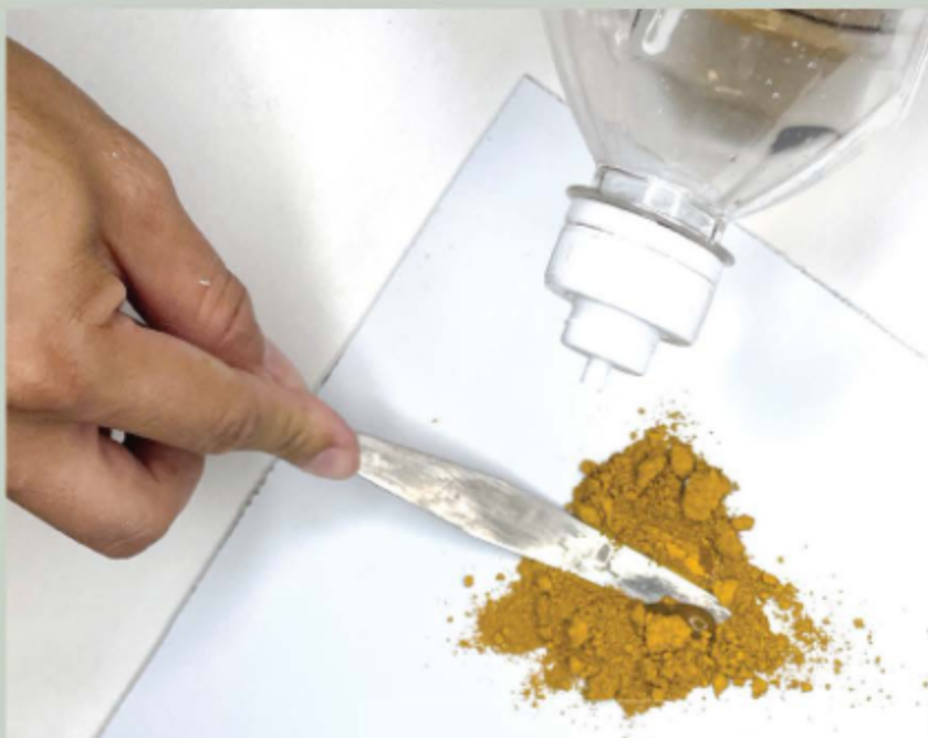
Bước 1: Lấy một lượng màu vừa đủ theo nhu cầu sử dụng hoà cùng keo
