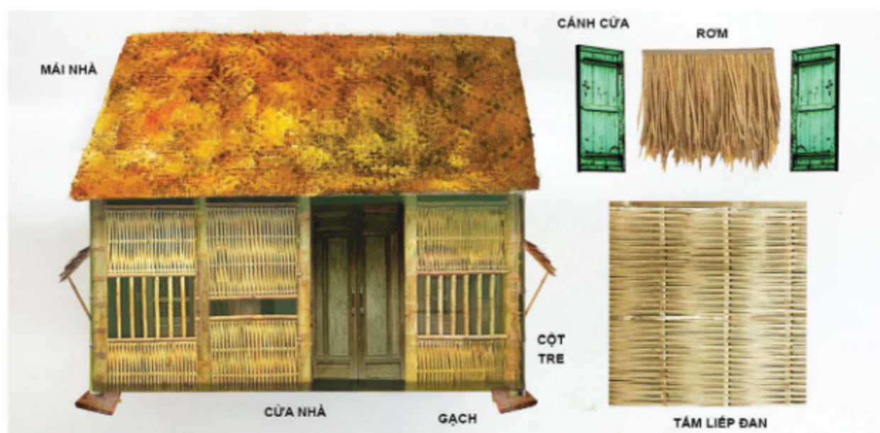
Mặt cắt phía trước, mặt bên và các thành phần trong bối cảnh dạng mô hình (1)
